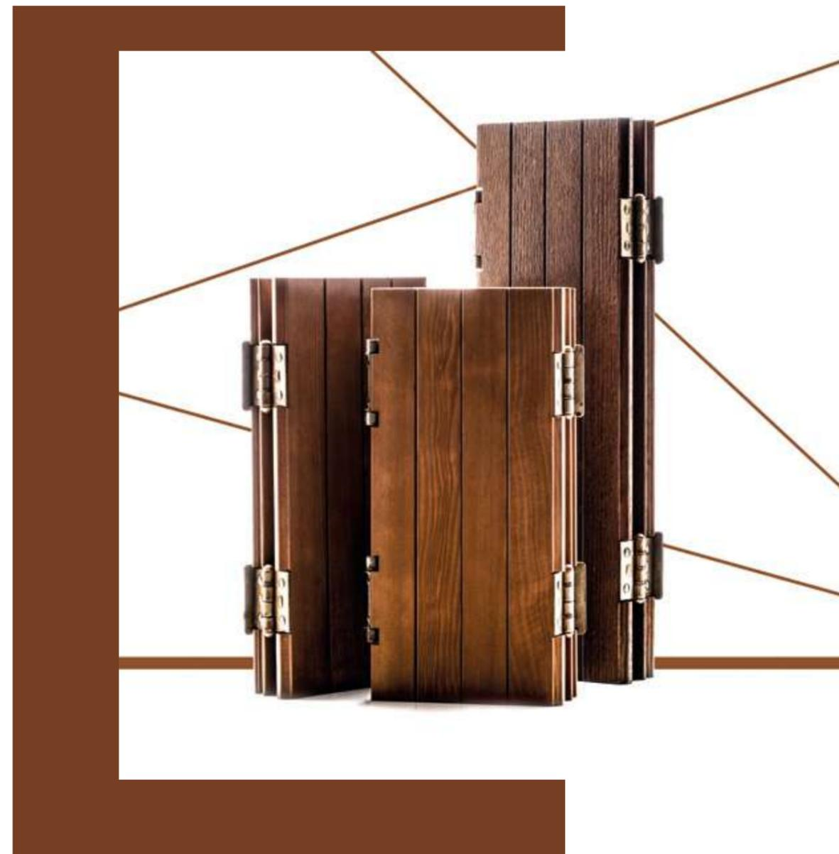
Le persiane ripiegabili in legno, di spessore 19 mm e con raccolta su uno o su entrambi i lati, possono essere da 1 a 4 per lato e sono costituiti da stecche verticali in massello con speciale profilo ad incastro, assiate ed armate con doppi tiranti passanti in ferro diametro 6 mm ribattuti sulle cerniere di articolazione.
