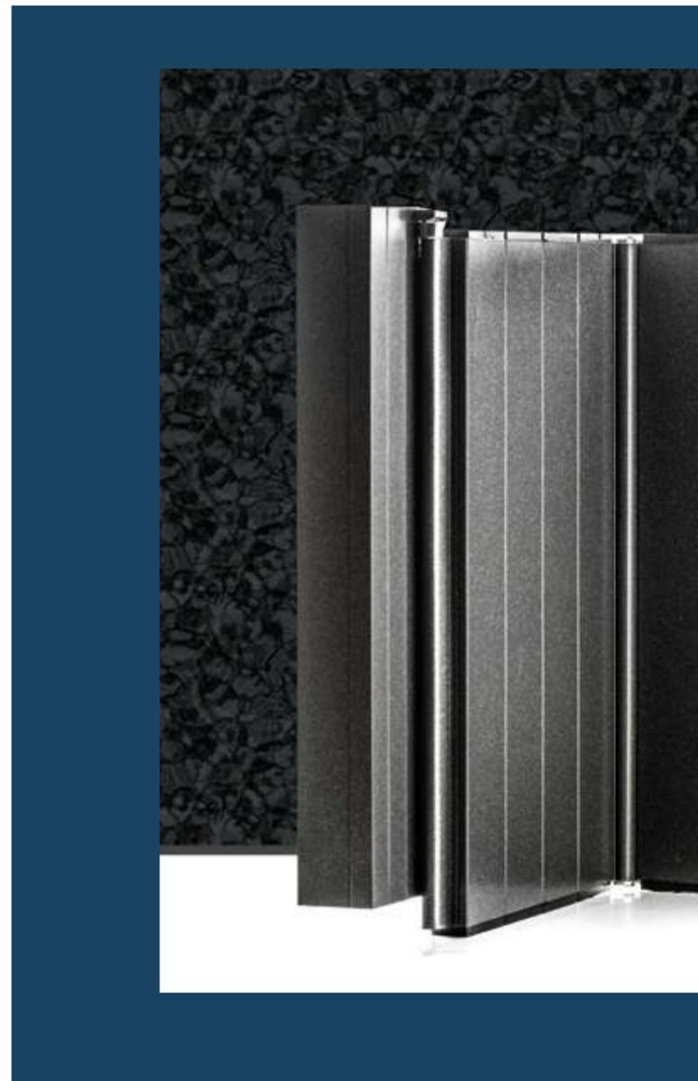
Le persiane ripiegabili in alluminio sono formate da pannelli di dimensioni variabili incernierati a montanti laterali con diversi tipi di attacco (telescopici da fissare a muro, con ricciolo in alluminio su serramento in legno predisposto e con profili speciali su serramento in alluminio). Eseguibili da uno a quattro pannelli per semiparte.
