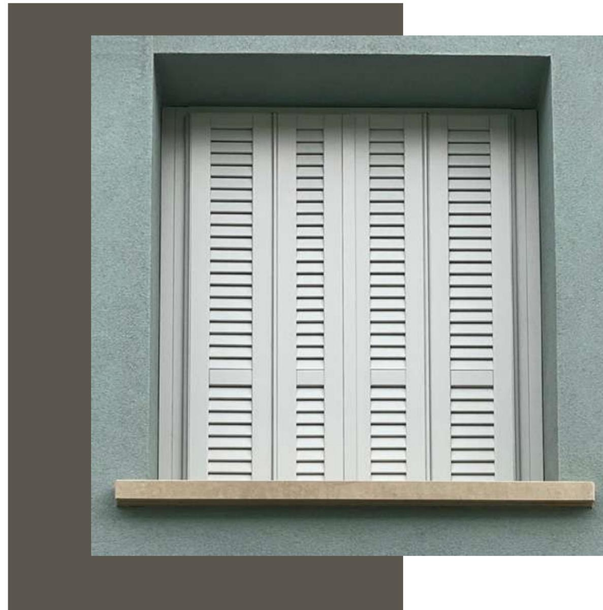
Pannelli, da 1 a 4 per parte, in alluminio estruso, con montanti laterali L 35mm e stecche orizzontali aperte sp. 50 mm, dotati di traverso orizzontale aggiuntivo, cerniere di articolazione integrate nelle doghe laterali di ogni pannello, che formano una costa verticale a tutta altezza.
