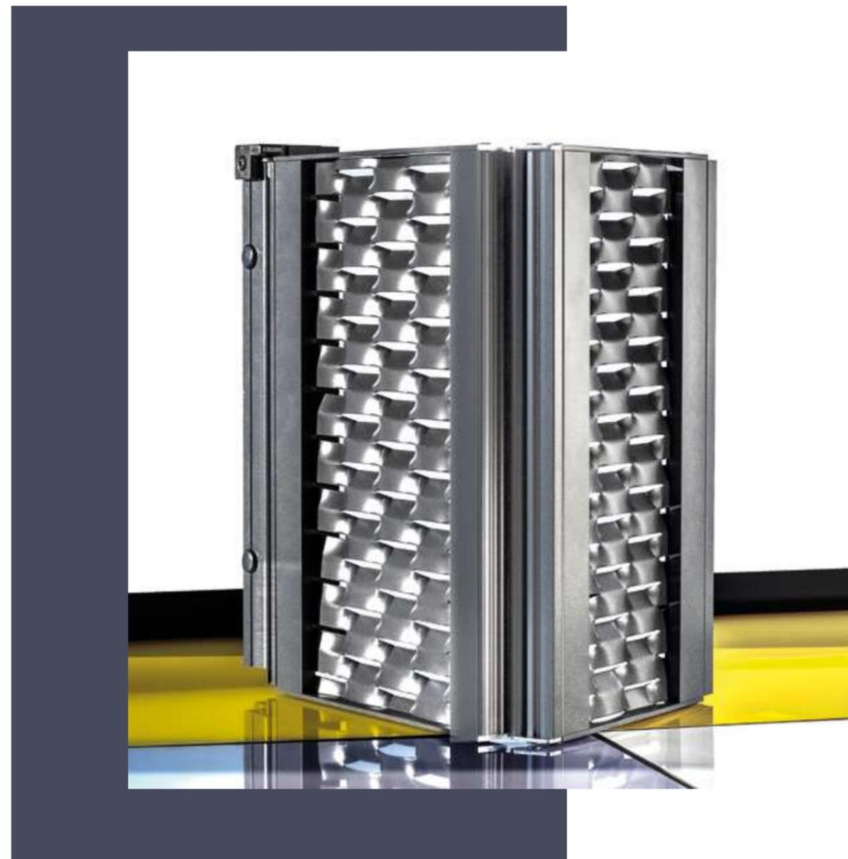
Le persiane ripiegabili in lamiera di alluminio sono formate da pannelli, di spessore 20mm, costituiti da lamiere in alluminio microforate o stirate, intelaiate con speciali elementi in alluminio estruso. Peculiarità del sistema Ital Jolly sono le cerniere di articolazione integrate nelle doghe laterali di ogni pannello, che formano una costa verticale a tutta altezza.
