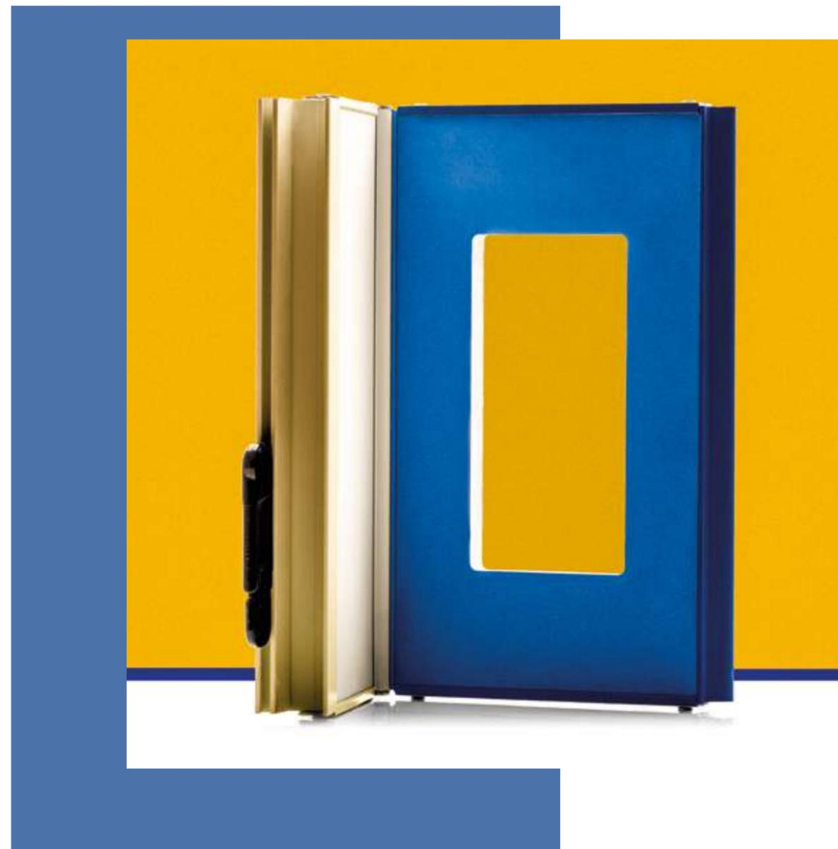
Le persiane ripiegabili in alluminio coibentato sono formate da pannelli di dimensioni variabili incernierati a montanti laterali con diversi tipi di attacco (telescopici da fissare a muro, con ricciolo in alluminio su serramento in legno predisposto e con profili speciali su serramento in alluminio). Eseguibili da uno a quattro pannelli per semiparte.
