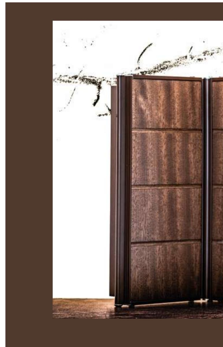
Pannelli, da 1 a 4 per parte, in legno multistrato ad incollaggio melamminico di classe 3 (normativa EN 314 a basso rilascio di formaldeide classe E1 EN 717-2 adatto per esterni e strutture marine), lavorati e fresati alle estremità per contenere e bloccare i profili delle cerniere di articolazioni a tutta altezza in alluminio estruso di diverse dimensioni idonee alla stabilità dei pannelli al ripiegamento e all'impacchettamento laterale.
