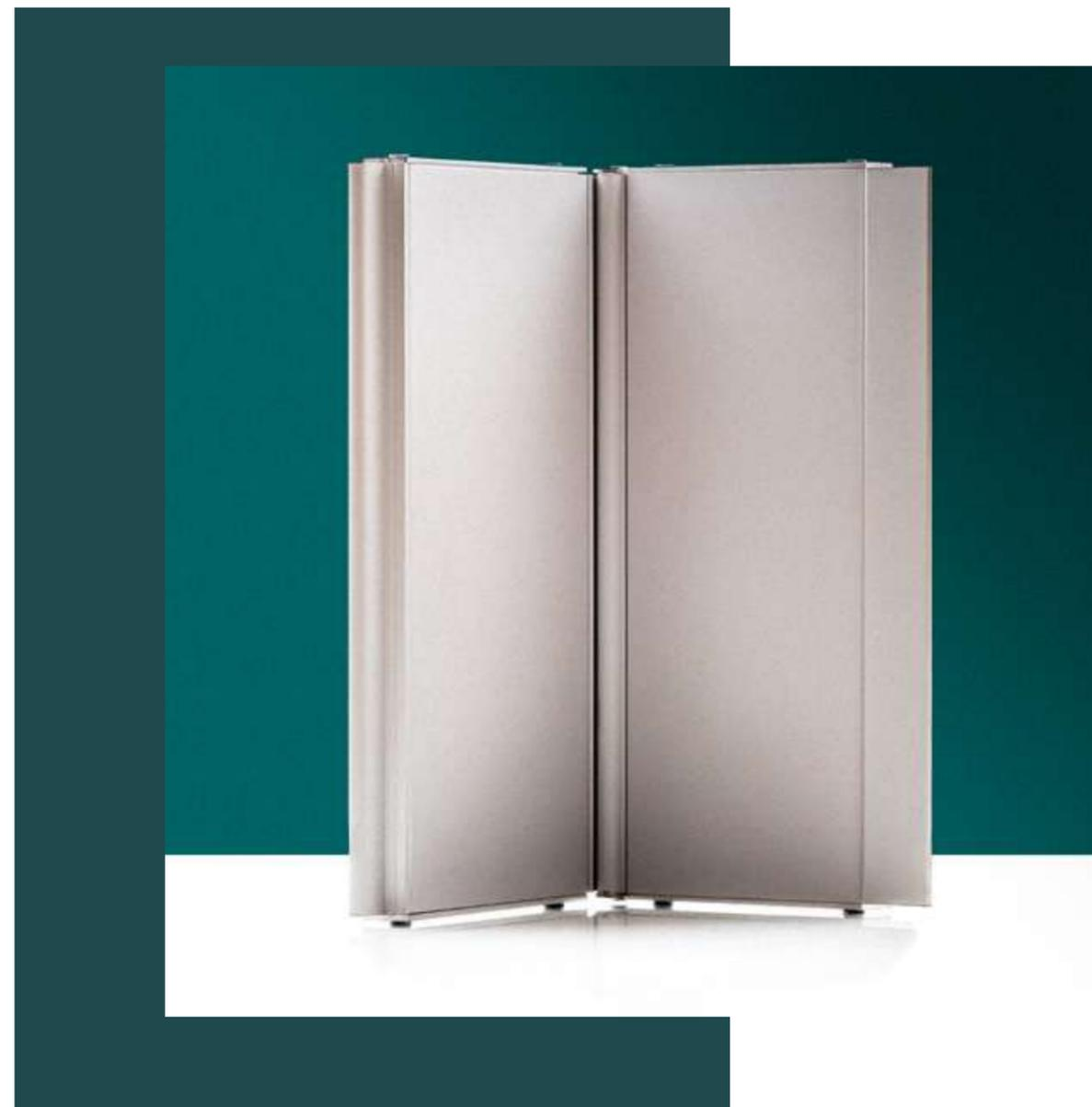
Pannelli, da 1 a 4 per parte, in materiale plastico strutturale 500 kg /mq addizionato a resine incollanti e compattanti. I pannelli vengono lavorati e fresati alle estremità per contenere e bloccare i profili delle cerniere di articolazioni a tutta altezza in alluminio estruso di diverse dimensioni idonee alla stabilità dei pannelli al ripiegamento e all'impacchettamento laterale.
