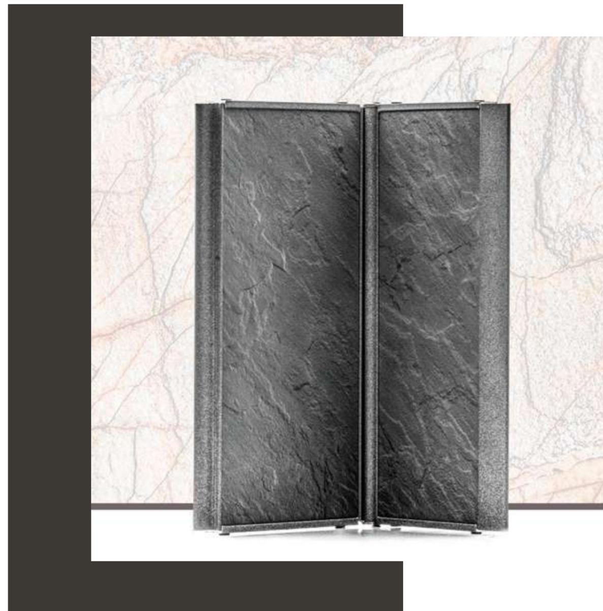
Le persiane ripiegabili in HPL coibentato sono formate da pannelli di dimensioni variabili incernierati a montanti laterali con diversi tipi di attacco (telescopici da fissare a muro, con ricciolo in alluminio su serramento in legno predisposto e con profili speciali su serramento in alluminio). Eseguita da uno a quattro pannelli per semiparte.
