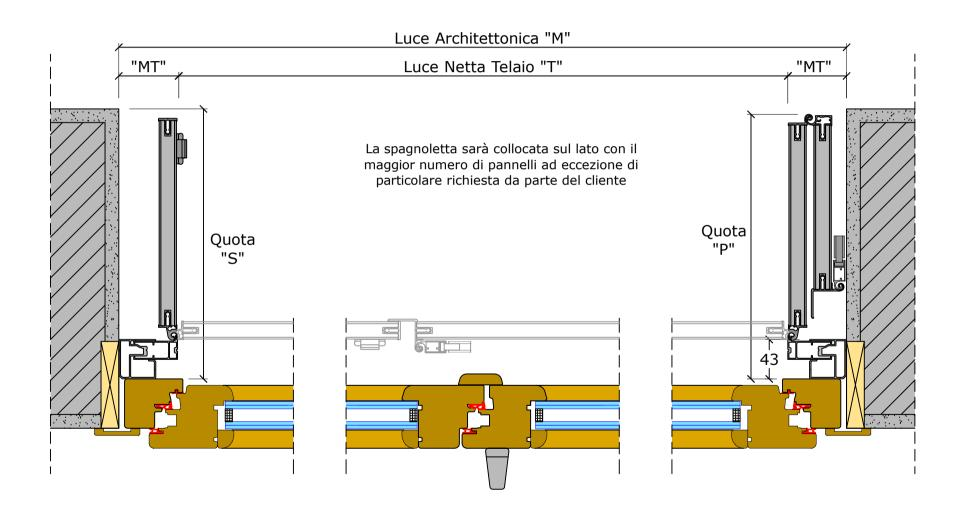
SEZIONE VERTICALE TIPO Con telaio telescopico
