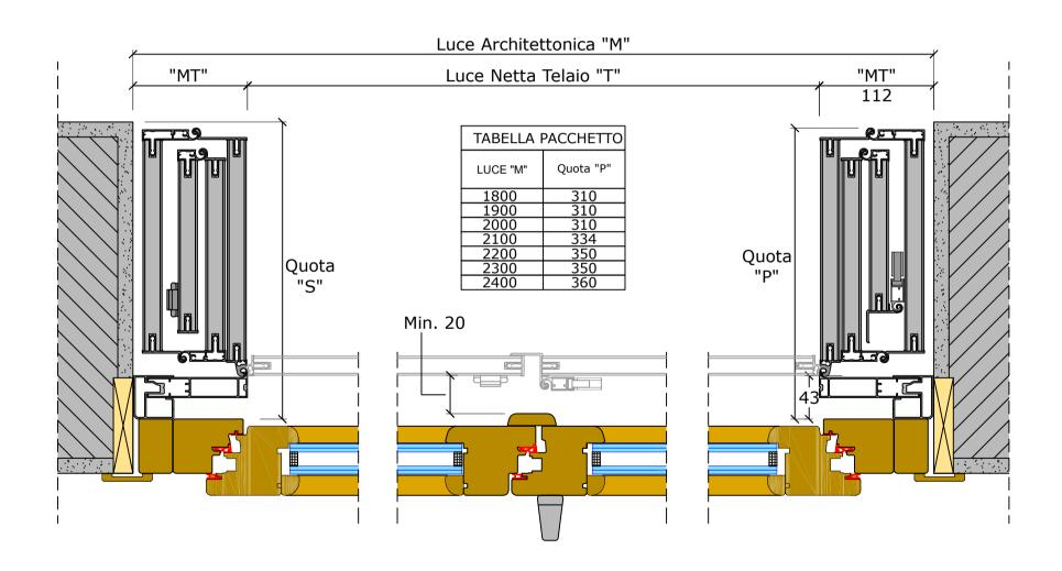
SEZIONE ORIZZONTALE RIPIEGABILE CON IMPACCHETTAMENTO SU UN SOLO LATO Con telaio telescopico
