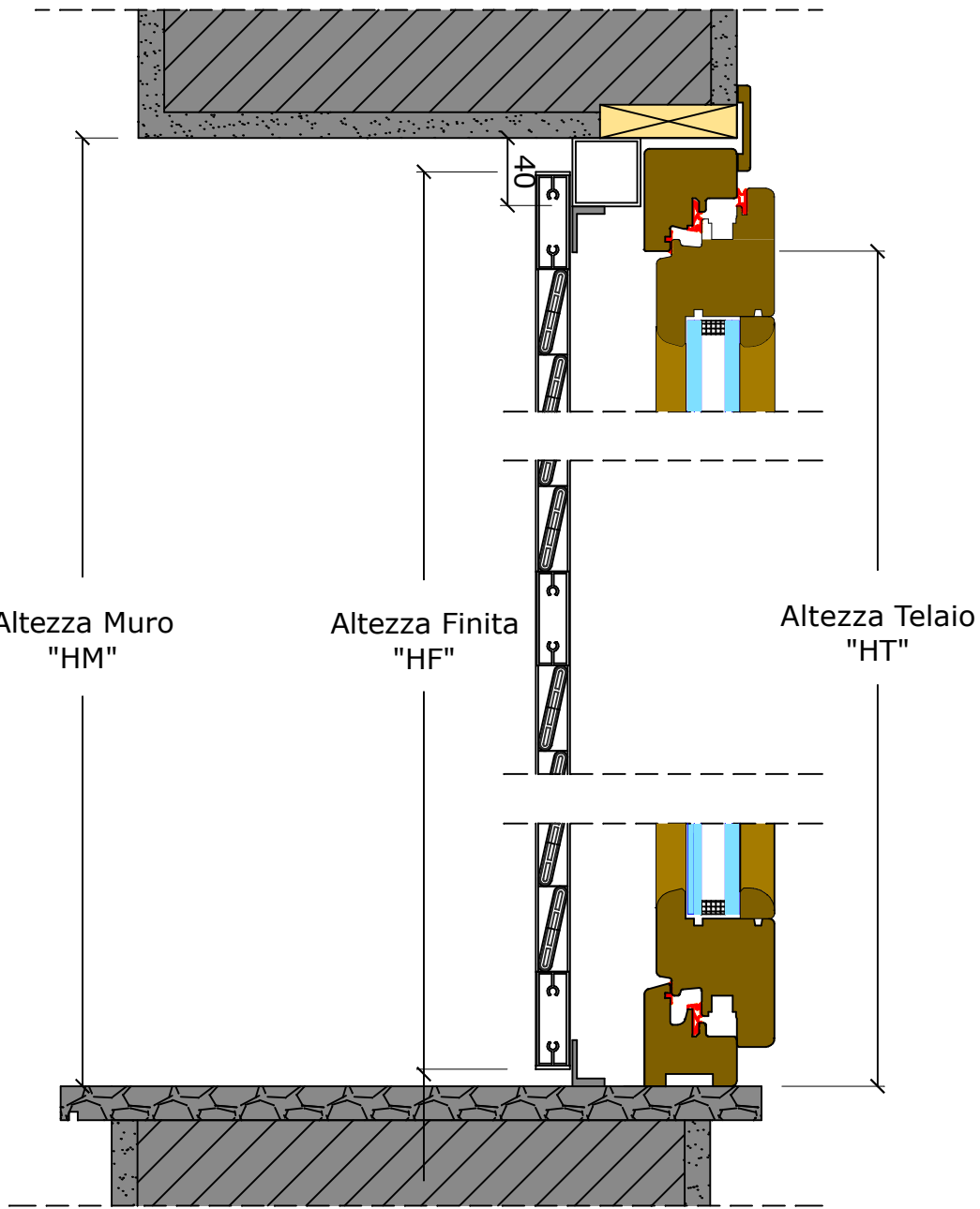
SEZIONE VERTICALE FINESTRA
